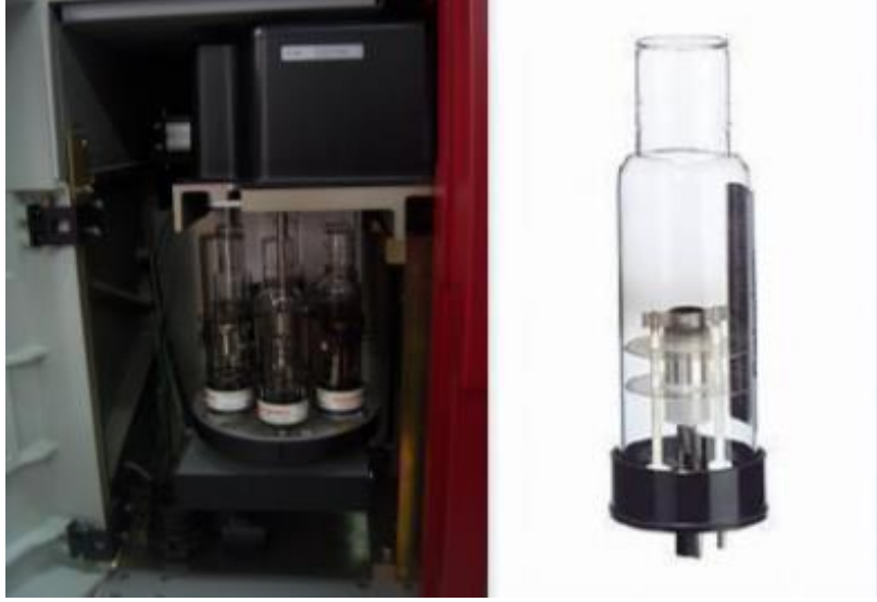
Şekil 2.5. AAS’de Lamba Kompartmanı ve OKL
