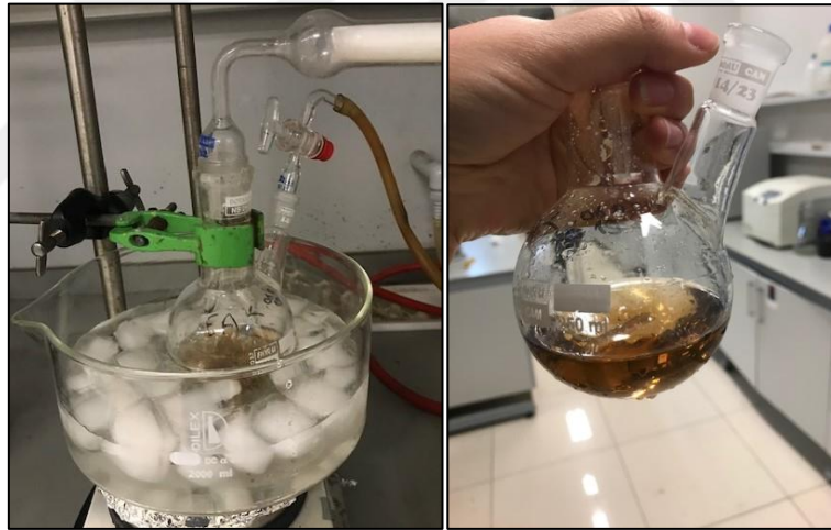
Şekil 2. 9 a) PAA sentez düzeneği b) 24 saat sonunda elde edilen PAA çözeltisi.
