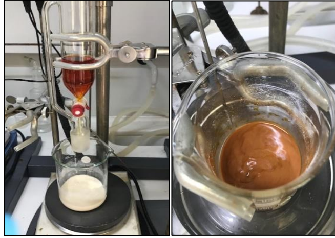
Şekil 2. 6 Islak emdirme yöntemiyle hazırlanan katalizör örneği.
