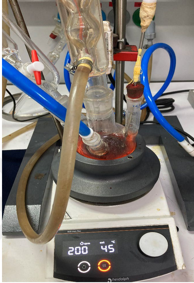
Şekil 3.2. Epokside edilmiş soya yağının reaksiyon düzeneği
