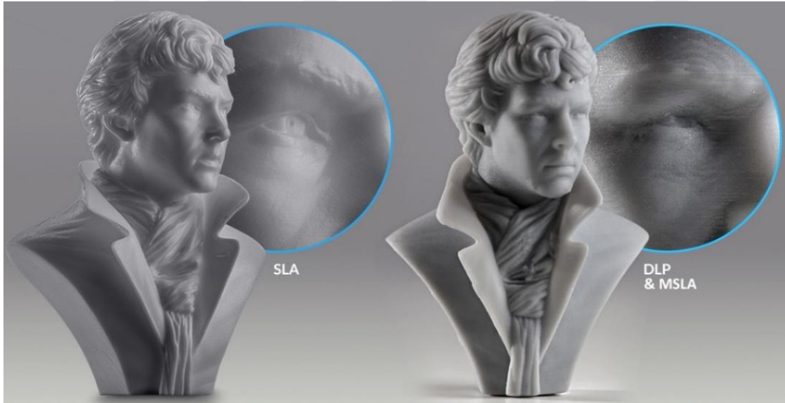
Şekil 2.28. Aynı 3B modelin SLA, MSLA ve DLP teknolojilerini kullanan 3B yazıcılardan alınan baskı sonuçları ve yüzey detayları
