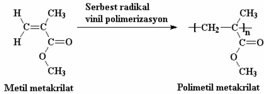
Şekil II.8 Metil Metakrilattan Polimetil Metakrilat Elde Edilmesi
