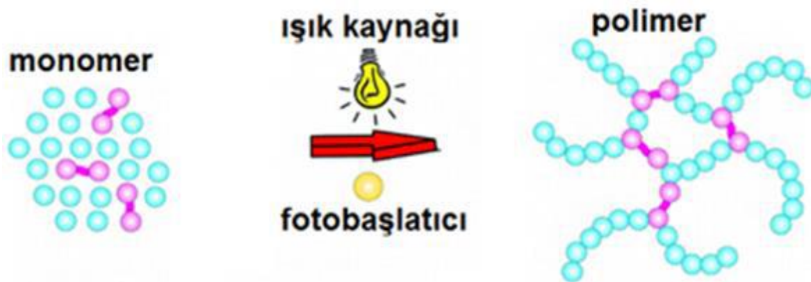
Şekil 7. UV Işınlarıyla Sertleşebilen Kaplama Prosesi [1,18]
