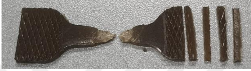
Şekil 3.15. SEM görüntüleri için alınan kesit
