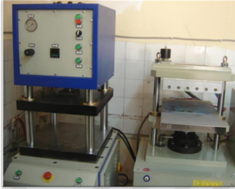
Şekil 3.4. Şekillendirme işleminin yapıldığı sıcak ve soğuk pres
