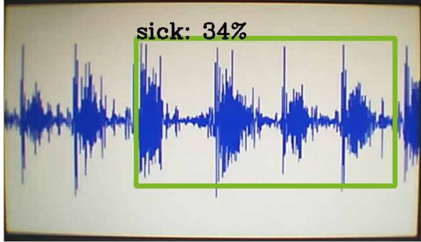
Şekil 4.7. Yolov3 Algoritması Çıktısının Kamera Görüntüsü Üzerinde Gösterilmesi
